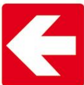
Chemin vers un matériel de lutte contre l'incendie
