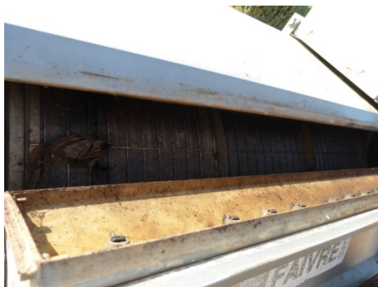
Figure 16 : Vue du tamis filtrant et de la toile
