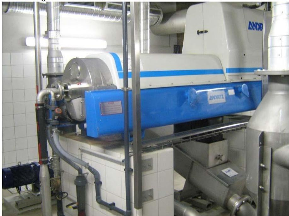
Figure 14 : Centrifugeuse (déshydratation des boues)
